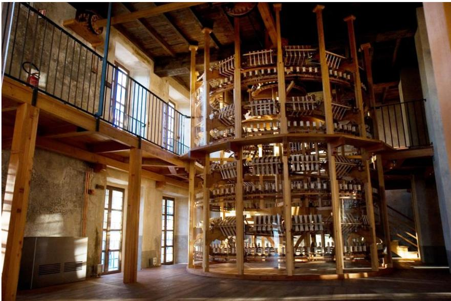
**Fig. 6.** Torno circular de seda de energía hidráulica a la piemontesa (Museo del Setificio Piemontese). (Imagen propia del autor).
