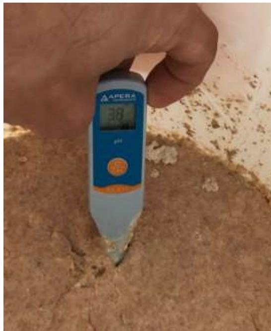
**Fig. 20.** Medición de PH de masa de cebada.
