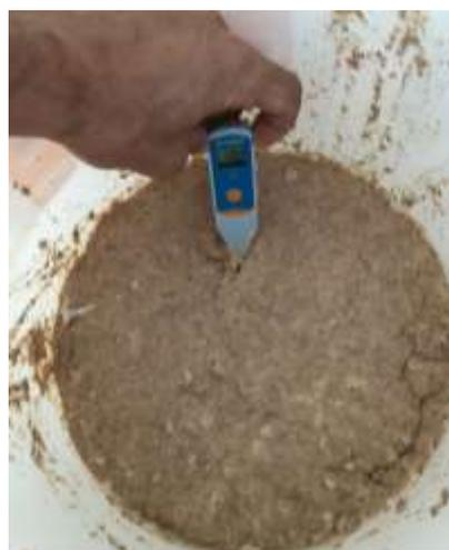
**Fig. 22.** Medición de PH de masa de escaña y avena.
