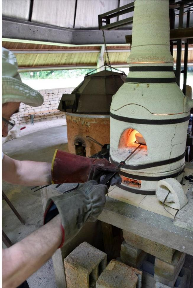
**Fig. 1.** Le four à moufle utilisé à Melle.
