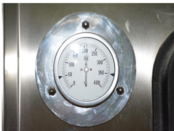
Fig. 27. Indicador de temperatura del horno indicando una temperatura de 220°C.
