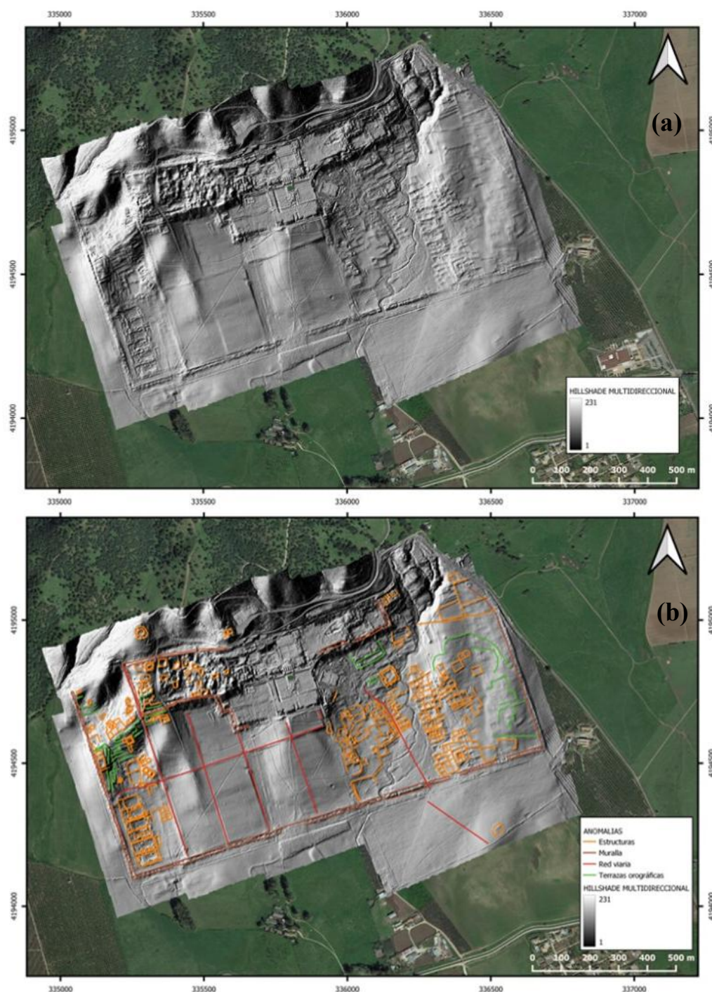
Fig. 5. (a) y (b). Adquisición LiDAR en Madinat Al Zāhira obra de M. Gasparini y de J. C. Moreno Escribano © Vallejo, A., León, A., Gasparini, M. y Moreno Escribano, J.C., «Actualización de la base topográfica y teledetección aérea a través de VANT del Conjunto de Madinat al-Zahra (Fase 1 del Proyecto General de Investigación "La medina oculta. La utilización de las nuevas tecnologías en la investigación y recuperación de la ciudad oculta de Madinat al- Zahra», Anuario Ar-queológico de Andalucía, https://www.juntadeandalucia.es/cultura/tabula/handle/20.500.11947/33821 .
