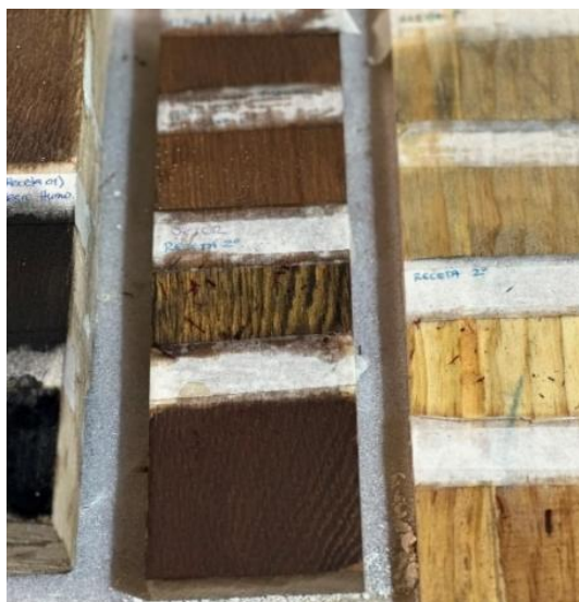
Fig. 7. Receta 2, versión palomina, variante 2. De izquierda a derecha, muestras en roble, fresno y pino.
