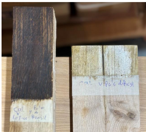
Fig. 8. Receta 2, versión palo de brasil, Variante 1. Resultado de la preparación del aceite machacando el palo de brasil, de izquierda a derecha en muestras de roble y fresno.
