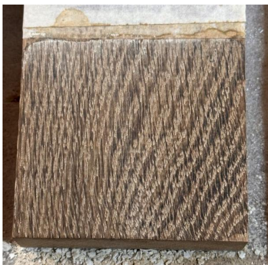
Fig. 10. Resultados de la aplicación de lejía de ceniza en roble.
