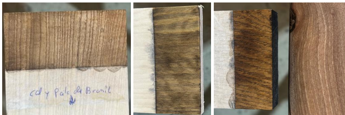
Fig. 1. Receta 1, variante 1. De izquierda a derecha, muestras de fresno, pino y roble. En extremo derecho, comparación con nogal original.
