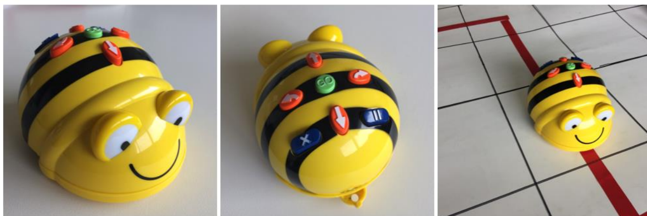
Figura 1. El robot Bee-bot (izquierda). Bloques de programación disponibles (centro). Tablero para actividades con Bee-bot (derecha). Fuente: elaboración propia
