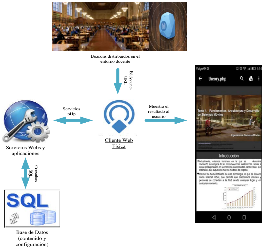
Figura 1. Arquitectura del sistema.
