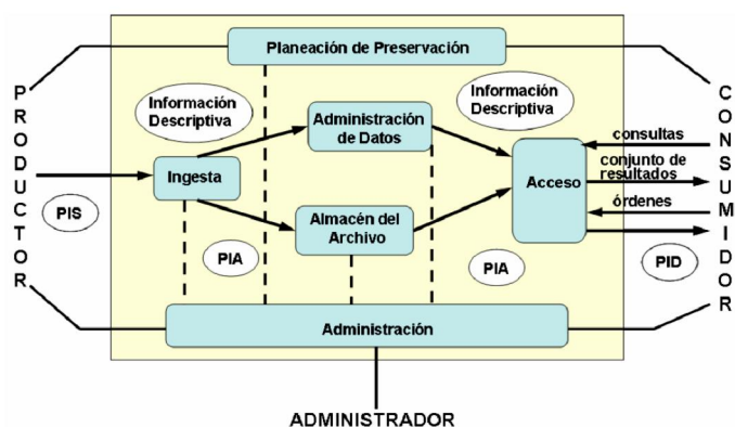
Modelo de entidades funcionales OAIS imitado en el sistema de biblioteca y mediateca digital del CNERU
